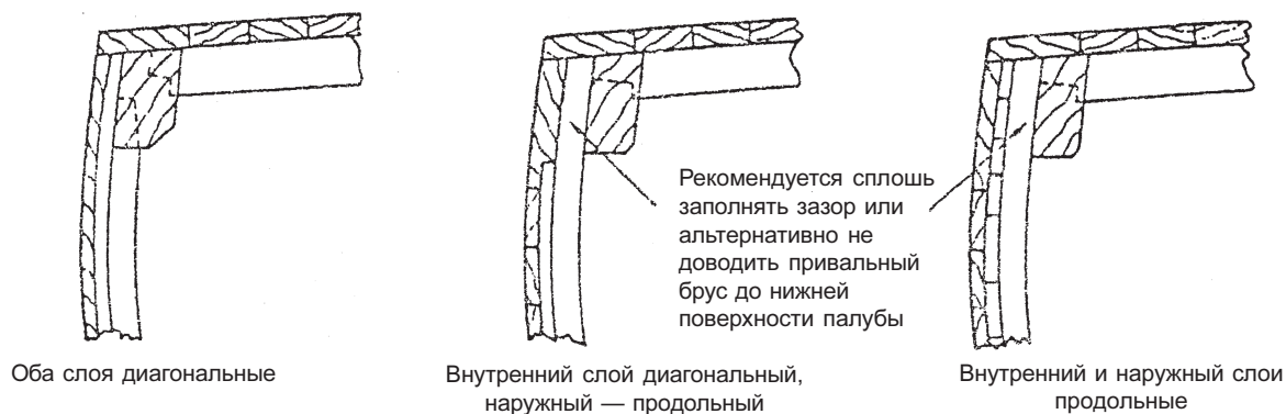
Рис. 4.9.6. Конструкция стыка борта с палубой при двухслойной обшивке
